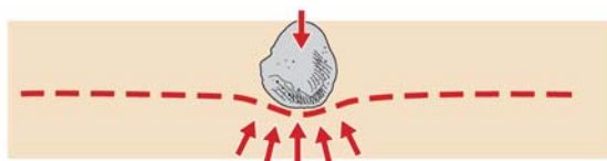
Obr. 10: Vysoká pružnost umožňuje geotextilii roztáhnout se v okolí pronikajícího kamene
